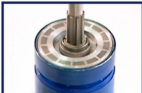
Mô tơ cửa cuốn sử dụng hệ thống phanh điện tử, tránh nguy cơ nóng chảy cuộn phanh và bộ chỉnh lưu khi quá nóng.
